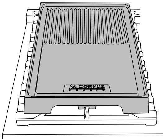
Die Platte nicht quer aufsetzen – sie passt nicht richtig und wird dadurch unstabil.
