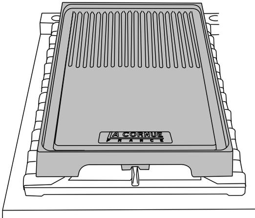
Ne la placez pas transversalement – elle sera mal placée et instable.
