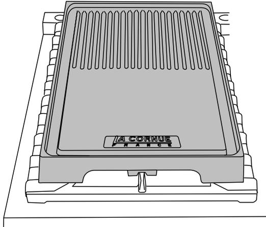
No la coloque en sentido transversal, ya que no encajará correctamente y será inestable.
