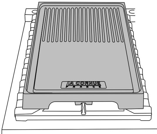
Não a coloque a grelha no sentido do comprimento, pois não fica bem encaixada e torna-se instável.
